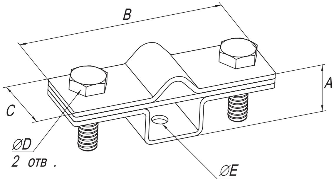
Держатель служит для крепления токоотвода. Конструкция дает возможность крепить прут  $\varnothing 6-10$  мм или полосу до 40 мм.
